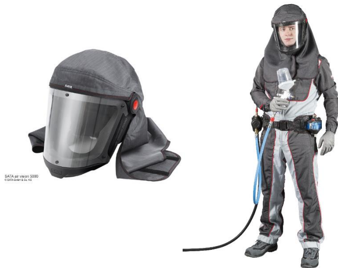
Abb.4: links: Haube für ein Druckluft-Schlauchgerät; rechts: vollständige PSA: Druckluft-Schlauchgerät nach EN 14594 der Klasse 3 mit Haube, Schutzbrille, Chemikalienschutzanzug (Typ 5) und Handschuhen. Der Druckluftschlauch wird am Gürtel angeschlossen und versorgt die Halbmaske und die Spritzpistole mit Luft.
