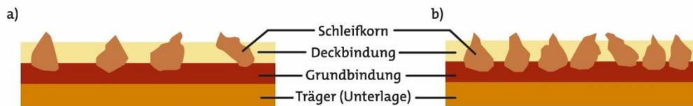
Aufbau von Schleifpapier ..... a) offene Streuung, b) geschlossene Streuung
