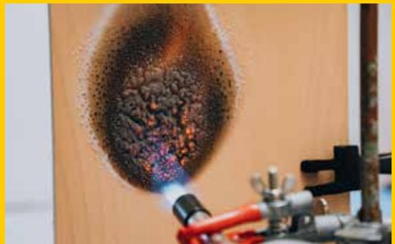
ADLER Pyrolan Beschichtungen verbessern das **Brandverhalten** wesentlich. Damit schaffen sie ein sicheres Wohngefühl und ermöglichen eine breite Verwendung von Holz- und Holzwerkstoffen als Baustoff unter Brandschutzauflagen.
