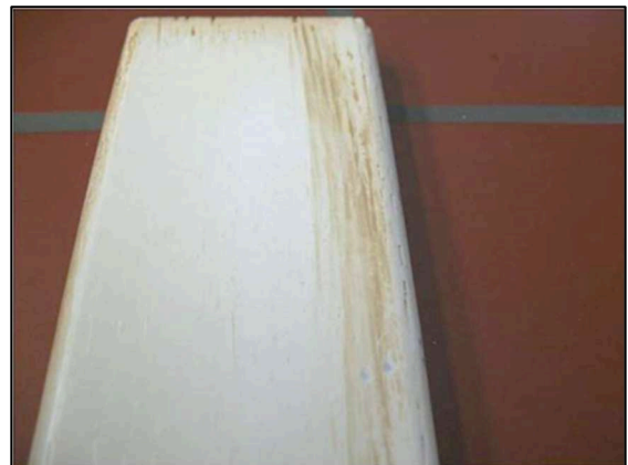
Abb. 2.5: Verfärbung des Beschichtungssystems durch Holzinhaltsstoffe
